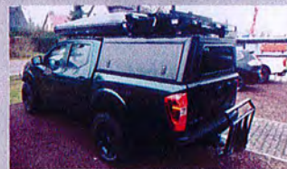
Fahrwerkshöherlegung +3,5 cm,Bodyliftkit + 8cm und Auflastung auf 3,5 Tonnen
